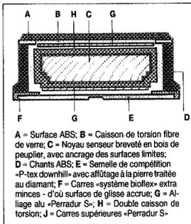
A = Surface ABS; B = Caisson de torsion fibre de verre; C = Noyau sensore breveté en bois de peuplier, avec ancrage des surfaces limites; D = Chants ABS; E = Semelle de compétition «P-tex downhill» avec affûtage à la pierre traitée au diamant; F = Carres «système biclives» extra minces - d'où surface de glisse accrue; G = Alliage alu «Perradur S»; H = Double caisson de torsion; J = Carres supérieures «Perradur S»
