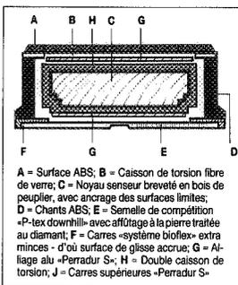
A = Surface ABS; B = Caisson de torsion fibre de verre; C = Noyau sensateur breveté en bois de peuplier, avec ancrage des surfaces limites; D = Chants ABS; E = Semelle de compétition «P-tex downhill» avec affûtage à la pierre traitée au diamant; F = Carres «système bioflex» extra minces - d'ou surface de glisse accrue; G = Alliage alu «Perradur S»; H = Double caisson de torsion; J = Carres supérieures «Perradur S»
