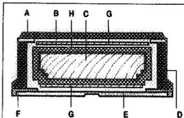
A = Surface ABS; B = Caisson de torsion fibre de verre; C = Noyau senseur breveté en bois de peuplier, avec ancrage des surfaces limites; D = Chants ABS; E = Semelle de compétition «Pax downhill» avec affûtage à la pierre traitée au diamant; F = Carres «système bioflex» extraminces - d'où surface de glisse accrue; G = Alliage alu «Perradur S»; H = Double caisson de torsion; J = Carres supérieures «Perradur S»
